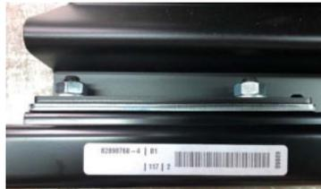
0.5.5 Konsole (Fahrzeugtypspezifisch): An der Konsole Türseitig (Aufkleber mit Artikelnummer z.B. 87.23.15)
