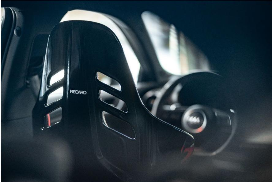
Die Podium GF verbindet hochfesten, ultraleichten Hightech-Schaum im Schalenkern mit einer Vorder- und Rückschale aus glasfaserverstärktem Kunststoff (GFK).
